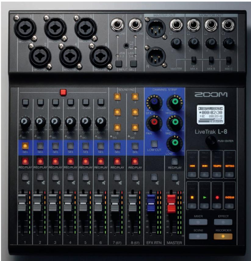
Über den Channelstrip kann jeder Kanal klanglich bearbeitet werden. Hier stehen das Panning, ein EQ mit High (10 kHz), Mid (2,5 kHz) . Low (100 Hz), ein Low-Cut (75 Hz, 12 dB pro Oktave) sowie ein EFX-Send mit den Effekten Hall 1, Hall 2, Room, Plate, Delay, Chorus, Vocal 1 und Vocal 2 bereit. Effekt-Parameter wie Tone, Decay, Time, Feedback, Time-Sync können ebenfalls feinjustiert werden. Ein Kompressor fehlt leider.
