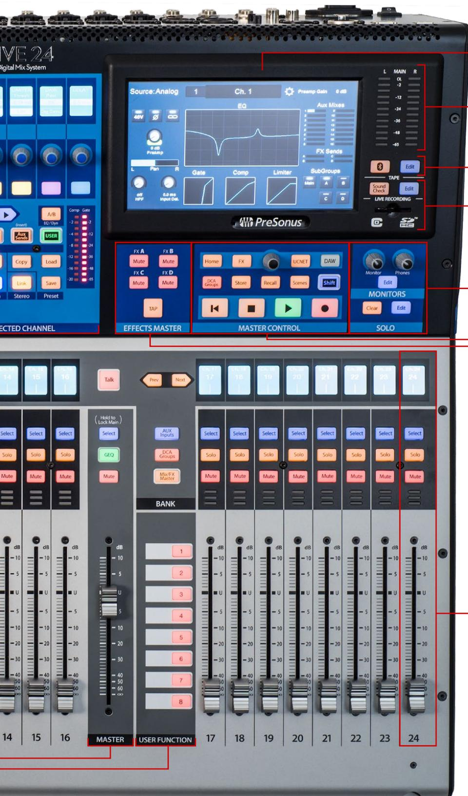
Der LCD-Touchscreen ist multifunktional. Hier hat der Nutzer stets alle wichtigen Parameter im Blick. Zudem werden hier unter anderem Kanäle benannt oder FlexMixes zugeordnet, DCA-Gruppen erstellt, Effektparameter eingestellt, die Capture-Software im Recording-Modus angezeigt und viel mehr.
