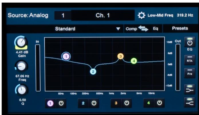
Verschiedene Equalizermodelle stehen zur Wahl. Die einzelnen Bänder lassen sich sowohl im Fat-Channel-Kontrollpanel als auch über den Touchdisplay einstellen.
