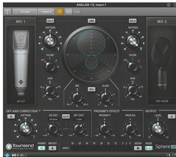
Im Dual-Mode kann zwischen zwei Models überblendet werden. Zudem stehen erweiterte Funktionen bereit wie Off-Axis Correction.
