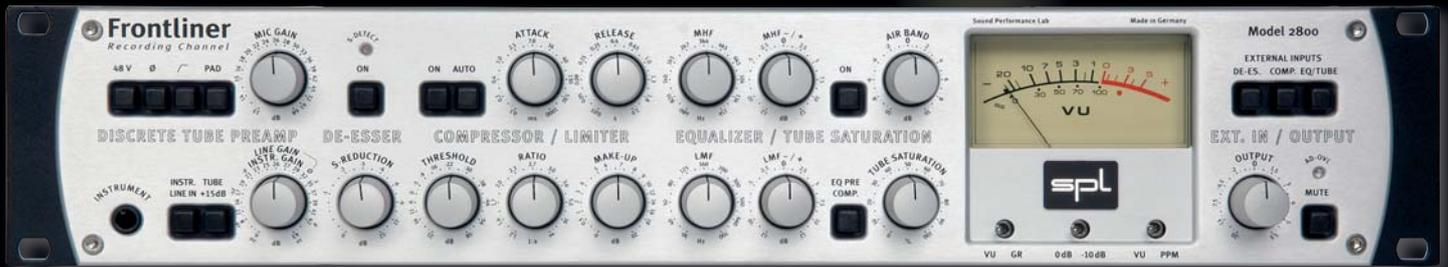
Die Anordnung der einzelnen Processing-Stufen auf der Frontseite entspricht nicht der Reihenfolge der Bearbeitung. Diese ist dank modularem Konzept jederzeit flexibel veränderbar.
