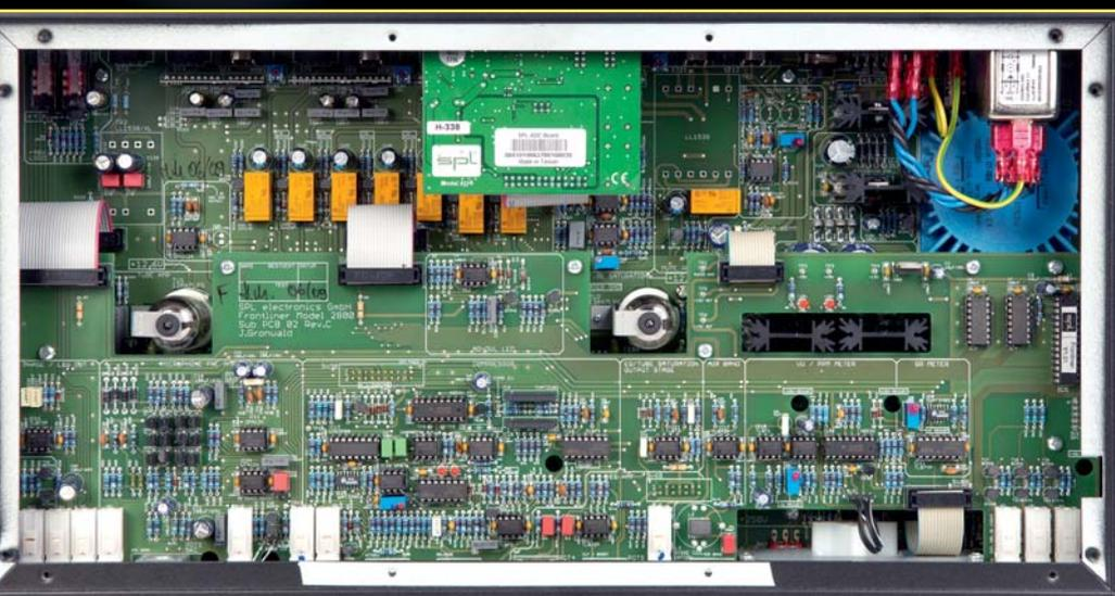
Der Frontliner ist auch innen sauber verarbeitet. Die beiden Röhren sitzen im Vorverstärker beziehungsweise vor der Ausgangsstufe. Eine Sternpunkt-Masseführung sowie zwei strikt getrennte Netzteile sorgen für einen sauberen Klang.
