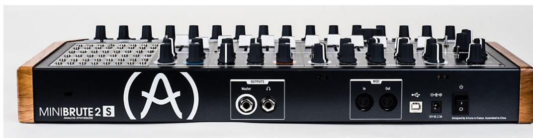
Die minimalistische Rückansicht des MiniBrute 2S. An Audioausgängen gibt es nur eine Kopfhörer- und eine Line-Buchse, beides in Mono. Externes Audio kann man aber über das Steckfeld einspeisen. Die externe Synchronisierung per Midi-Clock ist möglich.
