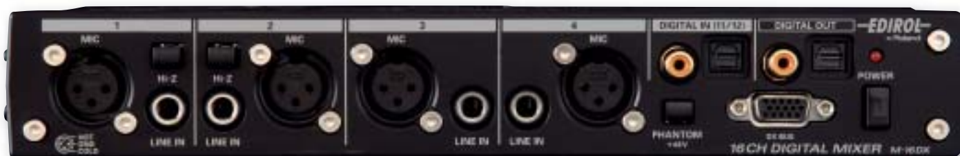
Alles, was gut zugänglich sein muss, befindet sich auf der Vorderseite des I/O-Moduls: Mikrofon-, Line- und Instrumenteneingänge, Digitalanschlüsse, Phantomspannungs-Taster, Power-Schalter und Sub-D-Buchse für die Verbindung zum Mix-Controller.
