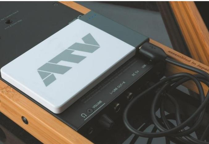
Sehr praktisch ist das schlanke USB-Batterie-Pack für die autarke Stromversorgung (alternativ zum Netzteil), das sich über Klettthafter fixieren lässt.
