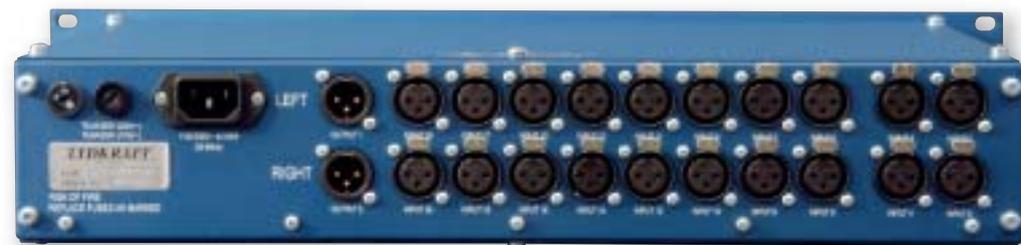
Keine besonderen Auffälligkeiten auf der Rückseite des Tube-Tech. Ein- und Ausgänge sind als solide XLR-Buchsen ausgeführt.
