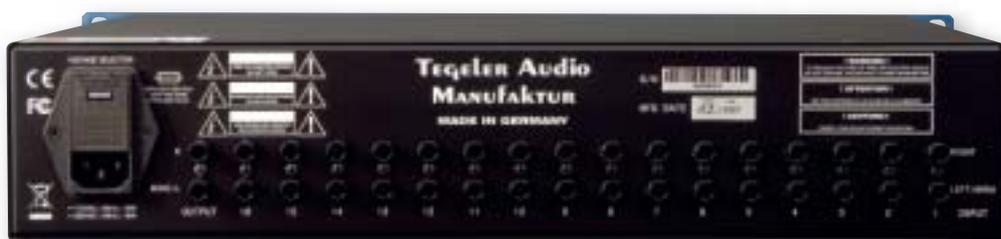
32 symmetrisch verschaltete Klinkenbuchsen nehmen die Stereo-Eingangssignale auf. Sollen nur Monosignale eingespeist werden, darf nur die untere Buchsenreihe verwendet werden.
