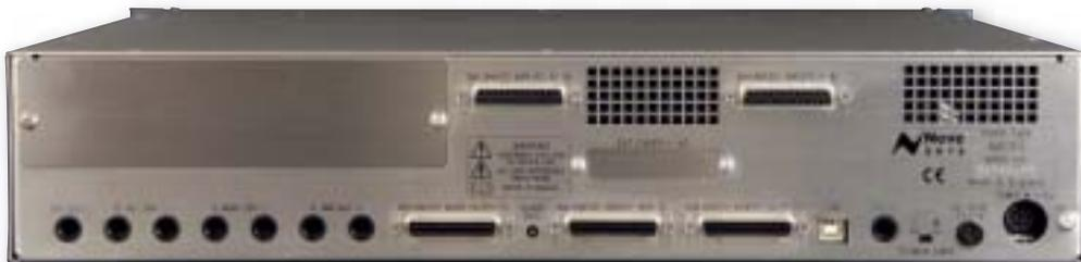
Neben einem USB-Anschluss nimmt der 8816 fast ausschließlich via SUB-D-Buchse und entsprechenden Breakout-Kabeln Kontakt mit der Peripherie auf. Einen Wandler-Einschub gibt es als Option.
