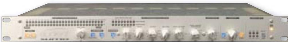
Der Audient Sumo ist gut ausgestattet, lässt sich leicht bedienen und bietet als nützliches Feature einen Einschleifweg in die Mastersektion. Als Option wird ein Wandler-Einschub angeboten.
