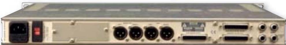
Anschlüsse bietet der Sumo reichlich. Zwei Sub-D-Buchsen nehmen über entsprechende Kabelpeitschen die analogen Eingangssignale auf. Inserts und Sends sind als Klinkenbuchsen ausgelegt.
