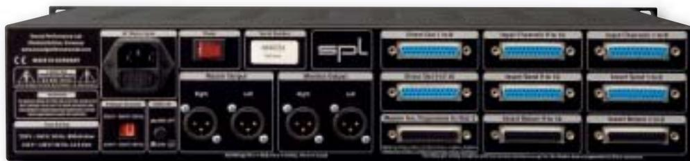
Der SPL bietet das reichhaltigste Arsenal an Anschlüssen. Eingänge, Direct Outs, Insert-Sends und Returns sind als Sub-D-Buchsen ausgelegt. Ein Ground-Lift-Schalter hilft, Brumm-Probleme zu beseitigen.
