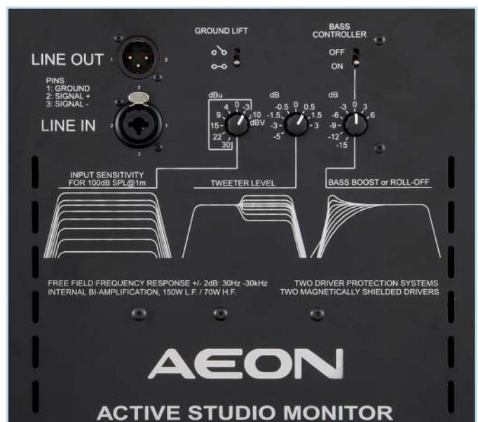
Ähnlich wie der Emes erlaubt auch der APS Aeon über zwei gerastete Drehregler die Einstellung des Hochtöner- und Tief-Mittel-Töner-Pegels. Der Ground-Lift-Schalter soll Brummschleifen vermeiden helfen.
