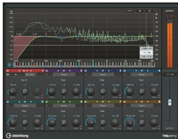
»Frequency EQ«: Acht Bänder lassen sich individuell im Stereo-, Dual- oder M/S-Modus betreiben.
