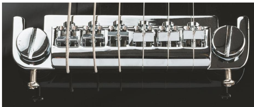
Individuell einstellbare Intonation an der Wraparound-Bridge der The '66
