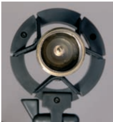
Gut zu erkennen ist der verbogene Kontaktstift für die Mikrofonkapsel im Gehäuse des T.bone SC 100 MkII.
