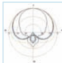
T.bone SC 100MkII: Hier zeigt sich ein unruhiger Frequenzgang mit einem Maximum bei 700 Hz. Ein weiterer Anstieg ist zwischen 4 und 10 kHz. Die Richtcharakteristik schwankt bei den einzelnen Frequenzen zwischen breiter Niere und Hypernieren. Verfärbungen des Umgebungsschalls sind damit programmiert.
