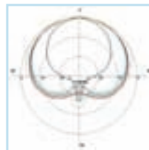
M-Audio Pulsar: Sehr ungleichmäßiger Frequenzgang, der, nach dem Maximum bei 6 kHz und einer Delle bei 8 kHz schnell abfällt. Diese Delle macht sich auch bei Beschallung von hinten bemerkbar. Das Polardiagramm deutet für Schalleinfall von hinten deutliche Verfärbungen an.
