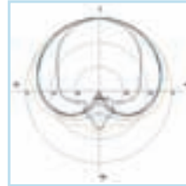
Beyerdynamic MC 930: Das Mikrofon zeigt im Frequenzgang einen recht guten Verlauf bis hin zu 10 kHz. Dort bekommt er eine Erhöhung um 4 dB und fällt dann um 20 dB bei 20 kHz ab. Das Polardiagramm zeigt eine gute Niere mit der üblichen Bündelung im Bereich 16 kHz.
