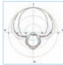
Audix ADX 51: Das Mikrofon mit dem unruhigsten Frequenzgang im Test. Erreicht erst ab 200 Hz den vollen Pegel. Bei 5 kHz Minimum bei 6,5 kHz ein Maximum. Das Polardiagramm entspricht dem einer Superniere. Deshalb wurde zusätzlich ein Frequenzgang unter einem Winkel von 130° aufgenommen.
