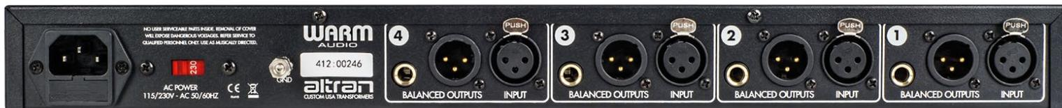
Auf der Rückseite des WA-412 reihen sich die vier Mikrofoneingänge und die paarweise vorhandenen Ausgänge (4 x XLR, 4 x symm. 6,3 mm Klinkebuchse) auf.
