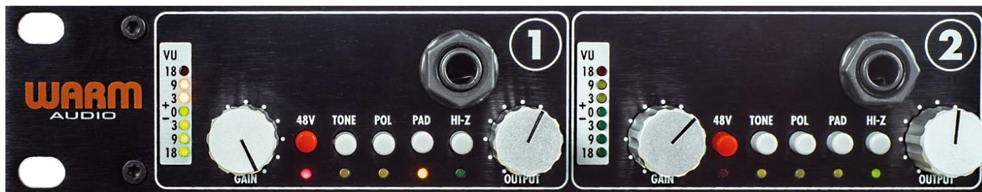
Pro Kanal wartet der WA-412 mit einer siebengliedrigen Pegelsäule, Gain- und Output-Poti, Schalter für Phantomspannung, Phasendrehung, Vordämpfung und Anpassung auf HiZ-Eingangsebene auf. Hinzu kommt je ein unsymmetrischer 6,3 mm Klinken-Anschluss zum frontseitigen Einstecken von HiZ-Instrumenten.
