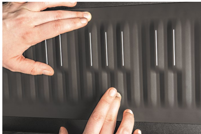
Sowohl die Keywaves als auch die Flächen darunter und darüber können gespielt werden – letztere fungieren als Ribbon-Controller und lassen stufenlose Modulation zu.
