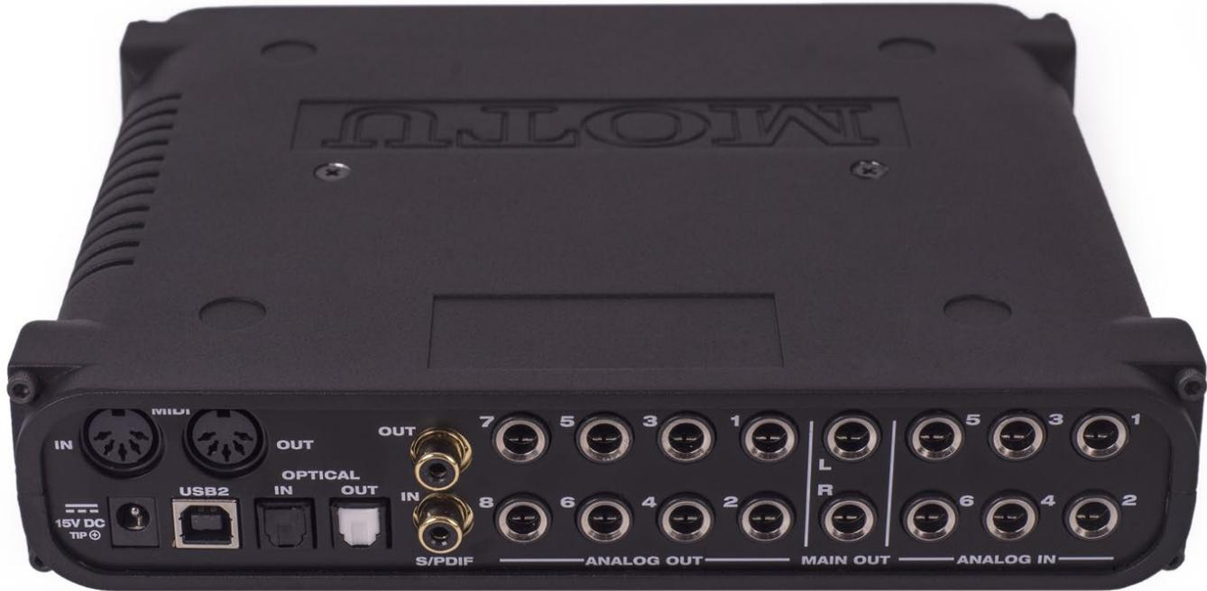
*Vielseitige Möglichkeiten auf engstem Raum – die Rückseite des UltraLite-mk4: 6 x 10 Analog (TRS), Midi I/O, Optische Anschlüsse und S/PDIF*
