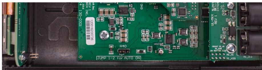
Durch das Umstecken einer Brücke im Innern des Geräts (s. unterer Rand) lässt sich der Einschaltvorgang umgehen. So schaltet sich das Interface automatisch bei vorhandener Stromzufuhr ein.
