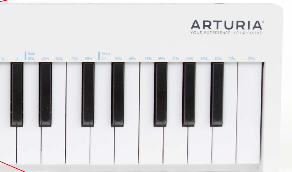
Shift-Taste zum Anwählen einer zweiten Funktions-Ebene; hier: Einstellen von MIDI-Kanal, Swing und Gate via Keyboardtasten für Arpeggiator und Sequenzer, Transponierung und Keyboard Play-Modus im Sequenzer-Betrieb
