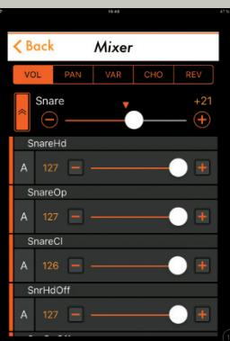
Die Anzeigen im Mixer-Menü entsprechen nicht ganz der Realität. Bei +21 ist die lauteste Einstellung der Instrumente im DTX700 schon erreicht, ...
