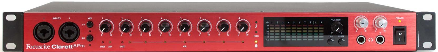
Auf der auffälligen roten Frontplatte versammeln sich sämtliche Bedienelemente sowie – praxisgerecht – die beiden auf HiZ umschaltbaren Combo-Buchsen 1 und 2 sowie die beiden Kopfhöreranschlüsse.
