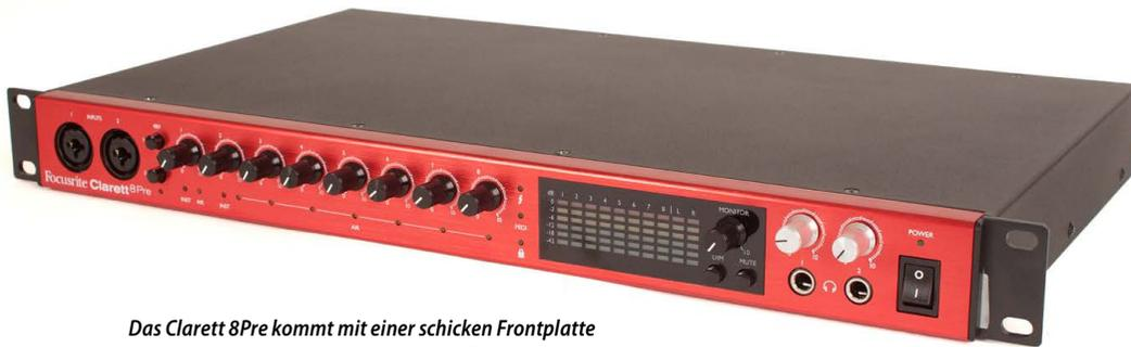
Das Clarett 8Pre kommt mit einer schicken Frontplatte in Rot-Metallic daher und nimmt als 19 Zoll-Gerät eine Höheneinheit im Rack ein.
