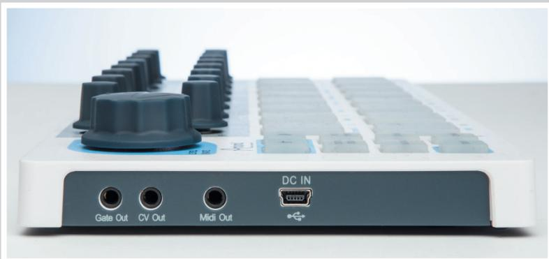
Möchte man BeatStep-Daten über Old-school-MIDI ausgeben, kommt der mitgelieferte Adapter mit dem typischen DIN-Anschluss zum Einsatz. Die CV/Gate-Ausgänge arbeiten mit 1 Volt/Oktave bzw. 8 Volt (Gate). Ein USB-Netzteil für den autarken Betrieb muss zusätzlich angeschafft werden. Auf der Rückseite gibt es zudem einen Kensington-Slot.
