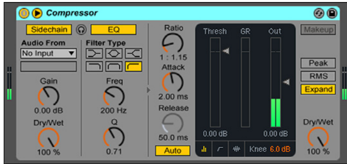
Lives altbewährtes Plug-in Compressor wurde mit einem Auto-Release-Modus, einem Dry/Wet-Regler, einer Upward-Expansion-Möglichkeit sowie einer detaillierteren Anzeige rundum optimiert.
