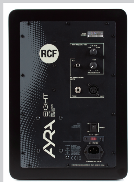
...der Empfindlichkeitsregler ermöglicht trotz etwas rudimentärer Skalierung den feinfühlig paarweisen Abgleich, zur Raumanpassung steht der „HF Adjust“-Regler zur Verfügung.
