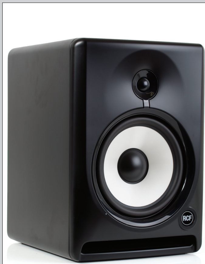
Auffällig ist neben der weißen Kevlar-Membran des Tief-Mitteltöners der drei RCF ARYA-Lautsprecher der Waveguide um den Hochtöner. Der Bass-Reflexport befindet sich auf der Vorderseite.
