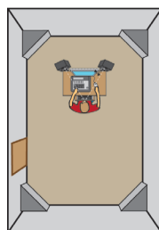
Hörraum mit Absorbern und Diffusoren
