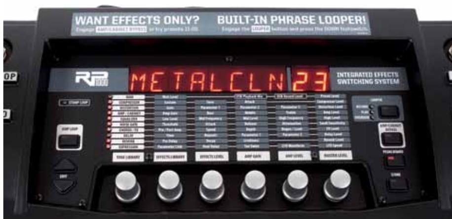
Die vergleichsweise filigranen Drehregler und die LED-Displays der Digitechs sind trittgeschützt ins Gehäuse eingelassen.
