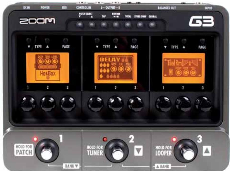
Dank der drei LCD-Displays und der beigeordneten Regler und Taster ist das Zoom G3 intuitiv bedienbar.
