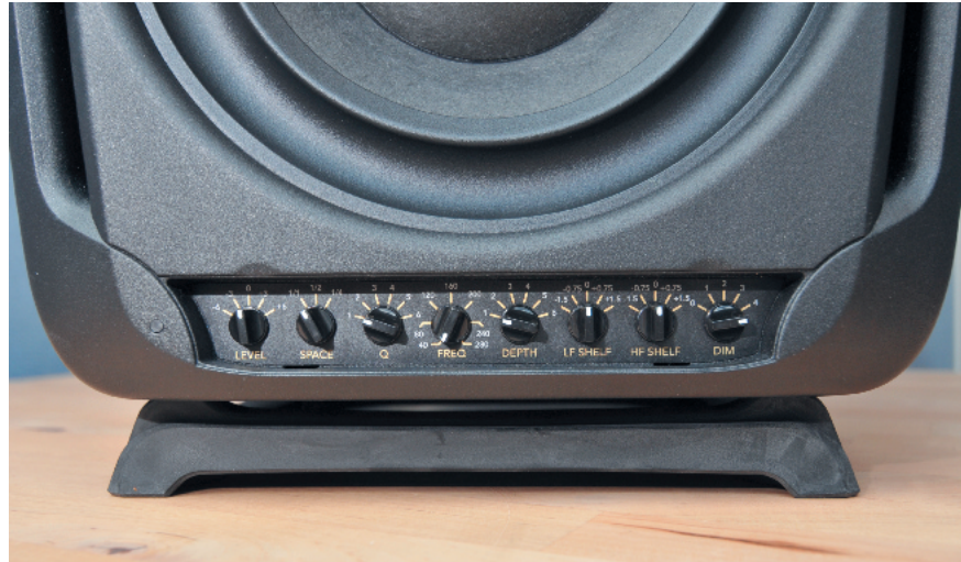
Hinter der Abdeckung befindliche Schalter und Regler für die Eingangsempfindlichkeit und Filter zur Ortsanpassung
