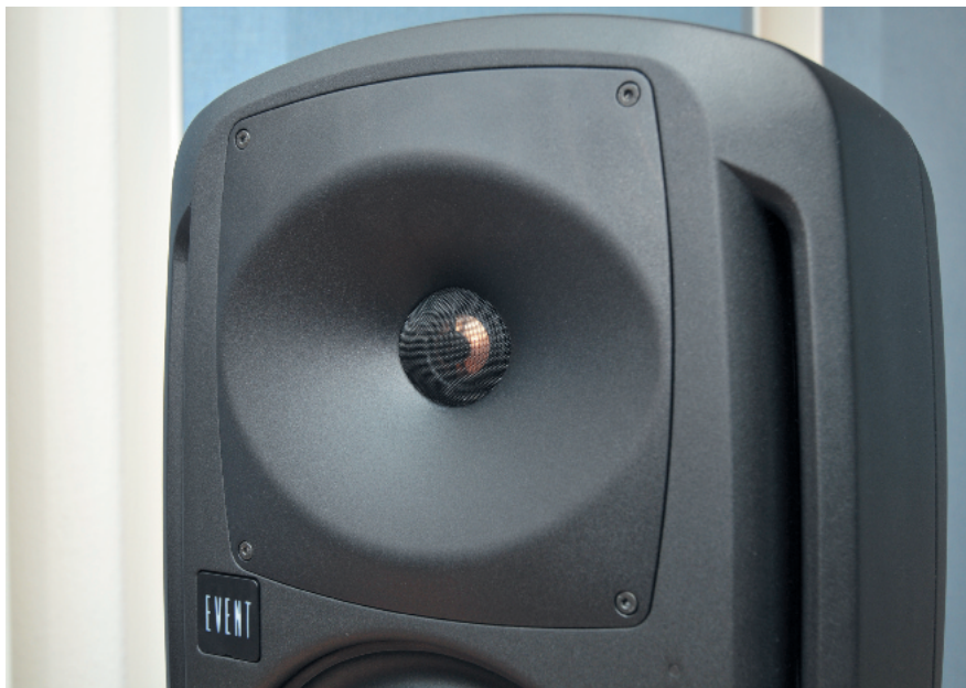
Der Hochtöner mit großem Waveguide, Phaseplug und Schutzgitter, seitlich liegen vorne die Bassreflexöffnungen
