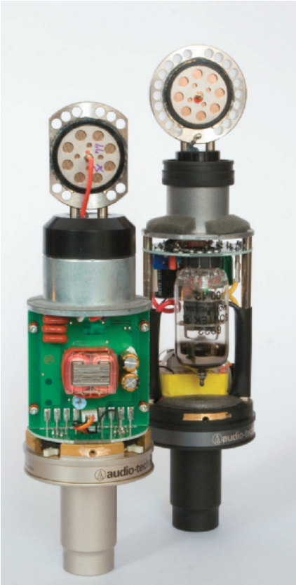
Abb. 1: Das AT4047MP (links) neben dem AT4060 Röhrenmikrofon: Das äußere Laufzeitglied um die eigentliche Kapsel ist an den Seiten beschnitten.
