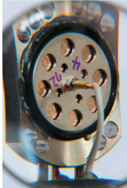
Abb. 2: Japanisches Hi-Tech, nur mit der Lupe erkennbar: Die Membran des AT4047MP hat eine Mikrostruktur.
