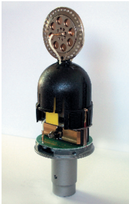
Suchbild: Die Miniaturröhre des AT 3060 steckt unten im Messing-Riegel, ein fetter Ausgangsübertrager verbirgt sich unter der schwarzen Plastikabdeckung.
