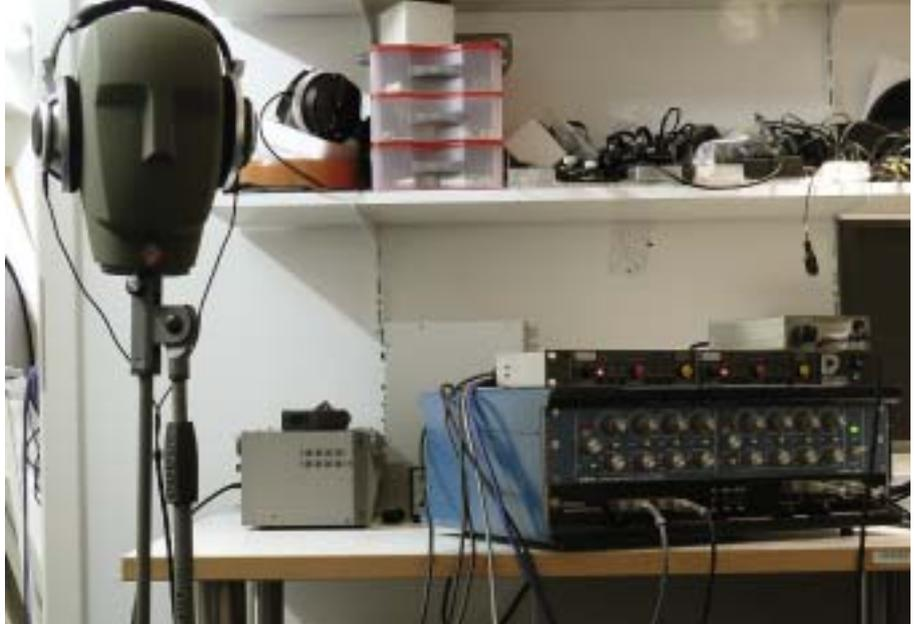
Für die exakte Ermittlung der Frequenzgänge im Messlabor dient der Kunstkopf Neumann KU 100, zusammen mit einem Analog-Equalizer von Orban, der die Kunstkopf-Mikrofone relativ zum Hörempfinden entzerrt.
