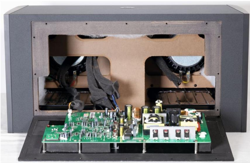
**Das Innenleben der Alpha Twin Evo: Die Elektronik findet auf einer großen Platine Platz. Das Gehäuse ist im Innern solide versteift.**
