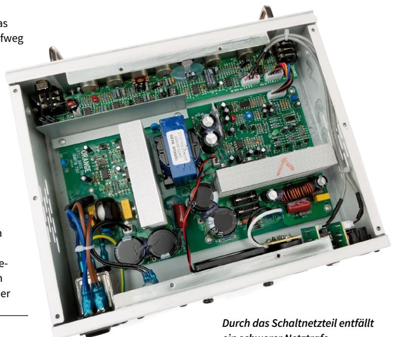
Durch das Schaltnetzteil entfällt ein schwerer Netztrafo.
