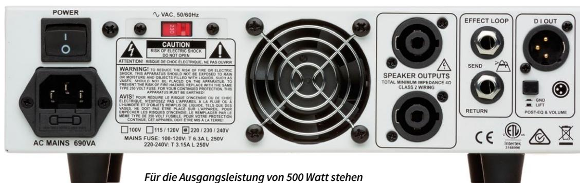
Für die Ausgangsleistung von 500 Watt stehen zwei Speakon-Ausgänge bereit.
