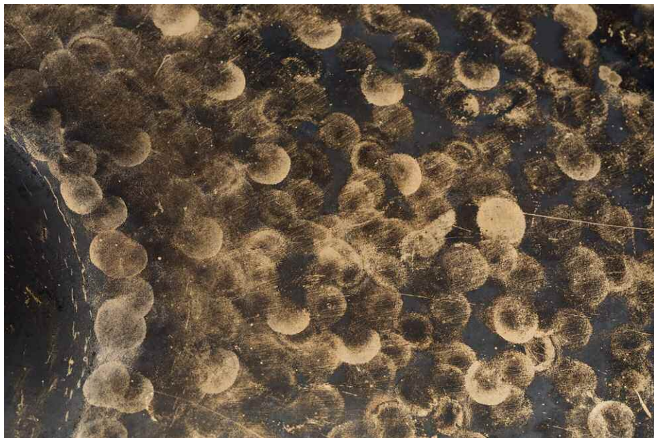
Die Hammereinschläge sind für die Feinabstimmung teils extrem dicht gesetzt.
