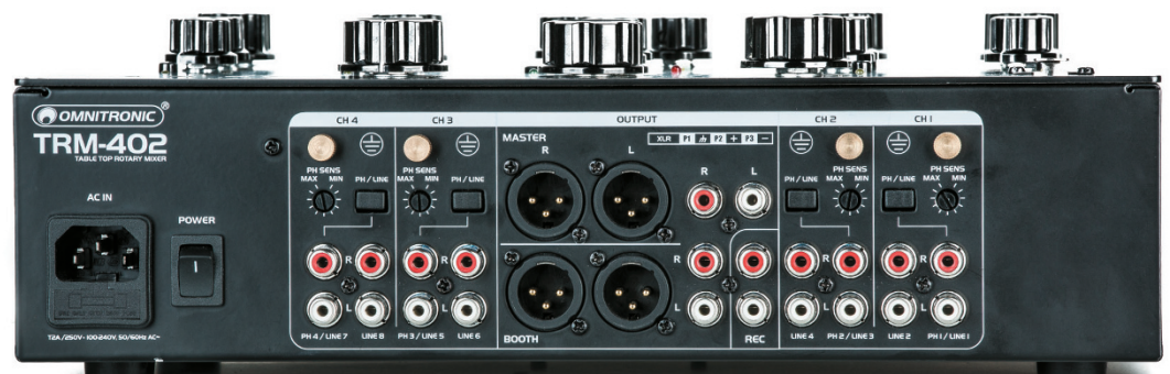
Die Rückseite bietet zahlreiche Anschlussmöglichkeiten für diverse Zuspierer. Master- und Booth-Ausgang sind vorbildlich als XLR-Buchsen konzipiert.
