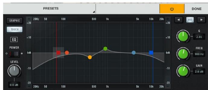
Alle Equalizer des OX stehen sowohl als graphische sowie als Touch-Version zur Verfügung
