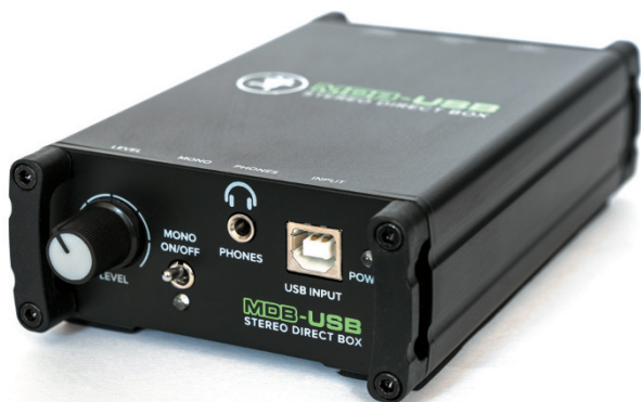
Mackie nennt seine MDB-USB eine DI-Box, dabei ist es ein Audio-Interface speziell für Bühnenanwendungen.
