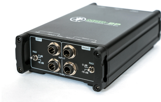
Die Mackie MDB-2P ist eine zweikanalige passive DI-Box. Vorne liegen unsymmetrische Instrumenteneingänge und Thru-Buchsen, ...
