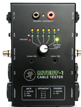
Auf beiden Flanken befinden sich die gleichen Steckverbinder: Klinke MIDI, Cinch, XLR (male/female) und Speakon. Mit dem Drehschalter geht man nacheinander die Kontaktpins durch. Außerdem auf der Oberseite: Miniklinkenanschlüsse und ein Durchgangsprüfer
