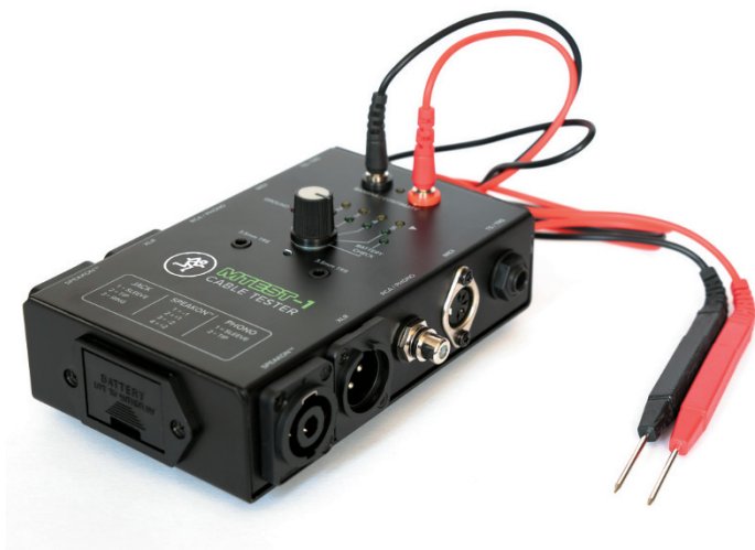
Mackies MTEST-1 ist ein praktischer Kabeltester für alle üblichen Audioverbindungen.
