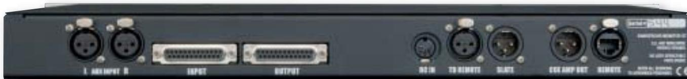
Die analogen Ein- und Ausgänge des Monitor ST liegen in Form von zwei 25-poligen Sub-D-Buchsen vor. Auf diesem Weg lassen sich drei Lautsprecherpaare plus Subwoofer, sowie vier Stereo-Signale anschließen.
