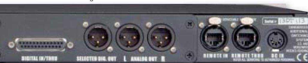
Platz für ein zweites Modul bietet das Gehäuse des A.S.S., das hier mit dem DAC-ST bestückt ist.
