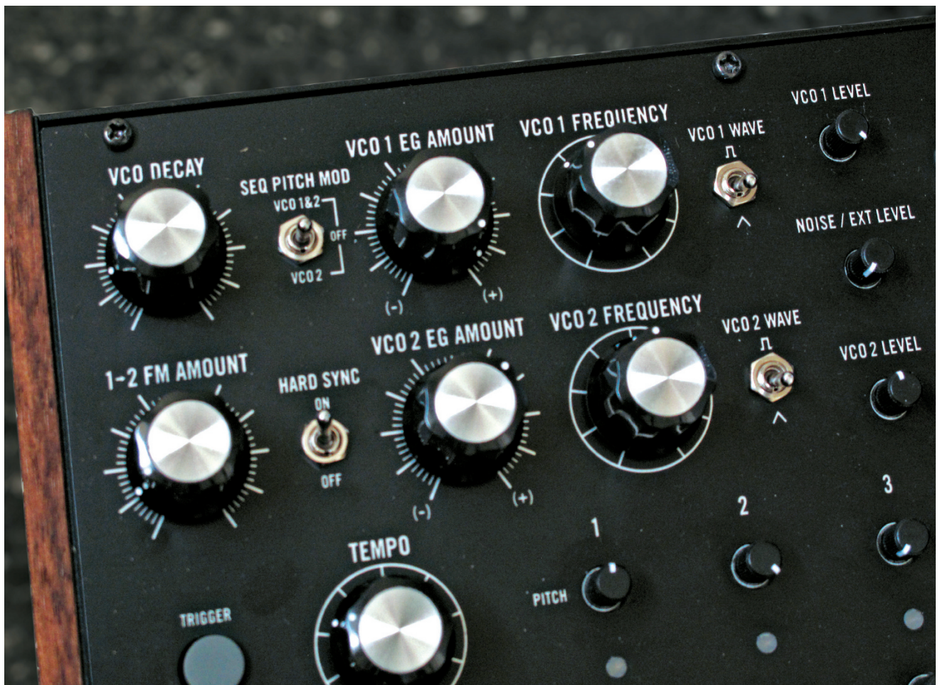
Die Oszillator-Sektion mit zwei Sägezahn/Rechteck-VCOs, Sync, FM und Pitch-Decay-Hüllkurve plus Noise-Generator; der Frequenzbereich ist riesig, die Stimmung dennoch zuverlässig stabil. Der Sequencer kann wahlweise die Tonhöhe von einem, beiden oder keinem VCO steuern.
