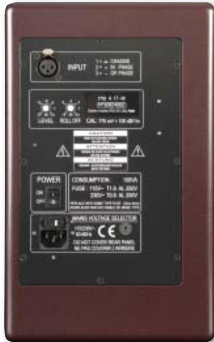
Anschluss- und Reglerseitig ist der A 17-M – wie alle Monitore von PSI Audio – aufs Wesentliche beschränkt. Mit dem LEVEL-Regler (Mitte links) lässt sich die Eingangsempfindlichkeit um maximal -10 dB herabsetzen. Der ROLL OFF-Regler (Mitte rechts) senkt die Frequenzen unterhalb 100 Hertz um maximal -20 dB ab und sollte bei wandnaher Aufstellung auf etwa -7 dB stehen. Bei Anschluss eines Subwoofers muss ROLL OFF auf Rechtsanschlag stehen.
