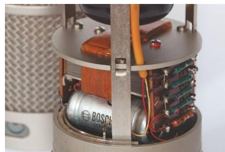
Neumanns Original mit dem legendären BV-08-Übertrager und den darunterliegenden, ebenfalls klangprägenden Bosch MP-Kondensatoren
