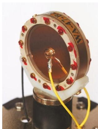
Die Kapsel des WA-47 ist eine Kopie von Neumanns K47/49. Die Warm-Audio-Kapsel wirkt sauber verarbeitet.
