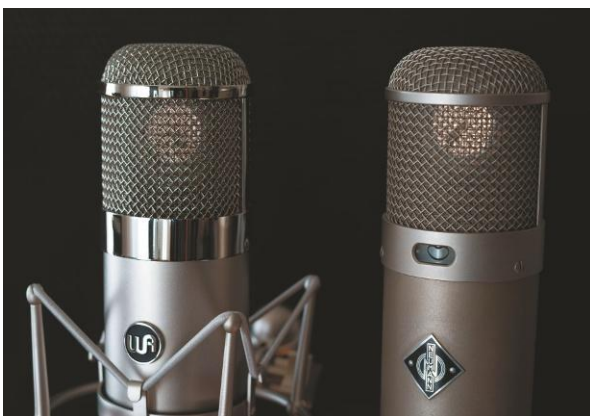
Die Kapsel des WA-47 (links) sitzt etwas tiefer im Mikrofonkorb als beim Original (rechts). Das hat klangliche Auswirkungen in den oberen Präsenzen.
