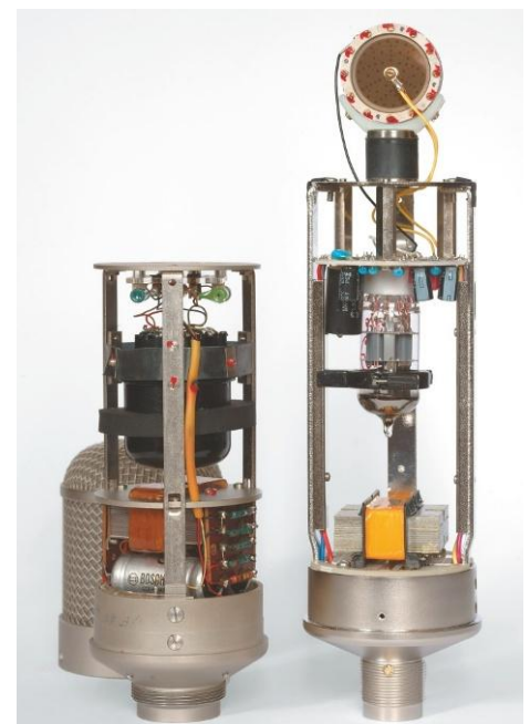
Original (links) und Warm Audios Kopie (rechts): Schon auf den ersten Blick erkennt man größere Unterschiede im inneren Aufbau.
