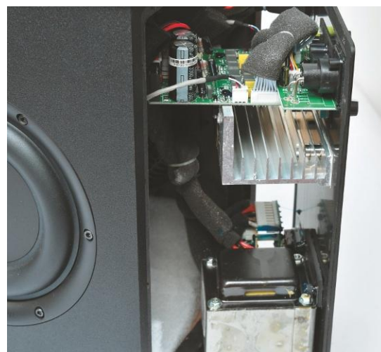
Einblick in die Elektronik mit analoger Filtertechnik und Class-AB Verstärkern
