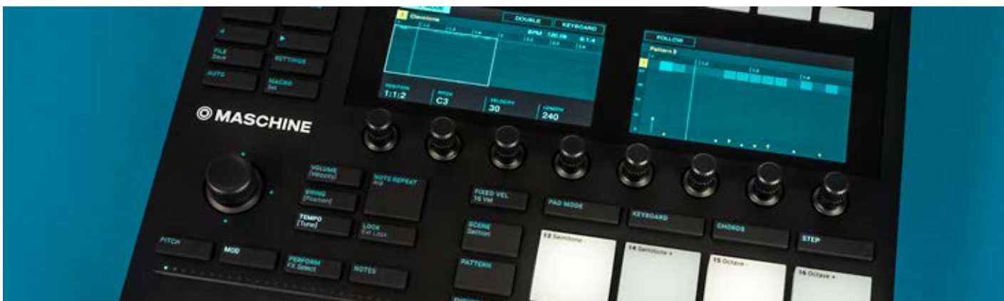
Die acht Drehregler unter dem Display dienen der Auswahl oder der Parameter-Justage. Unten links ist der Slider zu sehen
