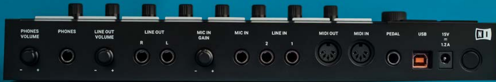
Die rückseitigen Anschlüsse. Für die direkte Aufnahme von Vocal-Samples steht der Mikrofon-Eingang mit separater Lautstärkeregelung zur Verfügung
