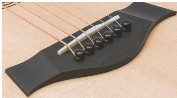
Ebenholzsteg mit klassischer Taylor Form; kompenzierte Stegeinlage, und die drei Justierschrauben für die Piezoelemente
