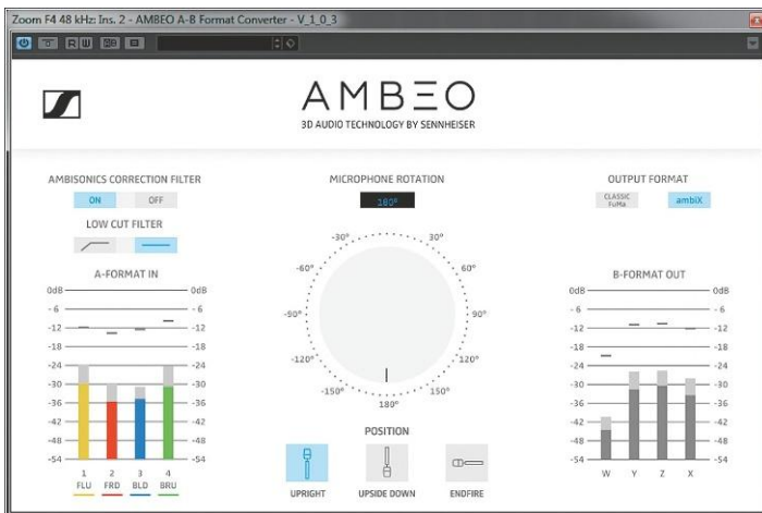
Der Sennheiser »AMBEO A-B Format Converter« macht aus dem Rohsignal des Mikrofons ein dreidimensionales Ambisonics-Signal, das für verschiedene Wiedergabesysteme dekodiert werden kann.
