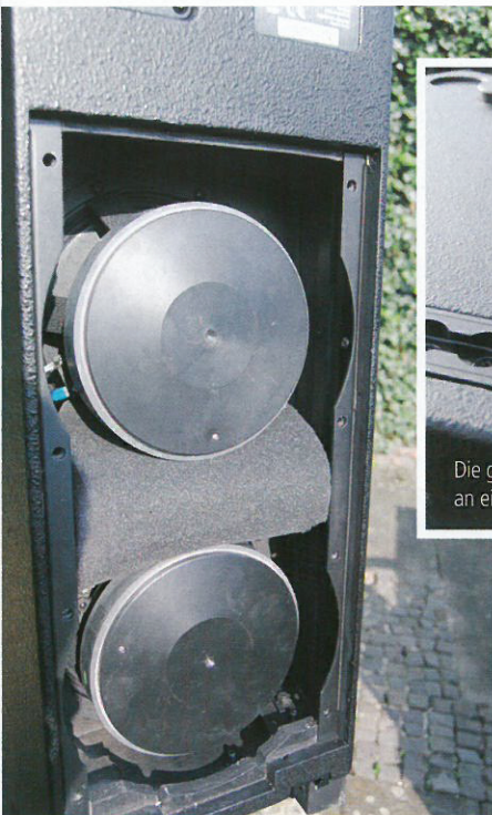
Trotz der verbauten zwei 8"-Ferrit-Treiber wiegt die 208H lediglich 36 kg
