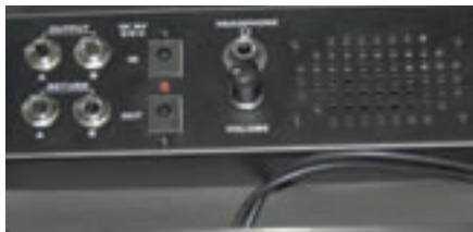
Das Anschlussfeld des PB5: Zusätzlich zu den Ein- und Ausgängen verfügt es über einen Miniamp.
