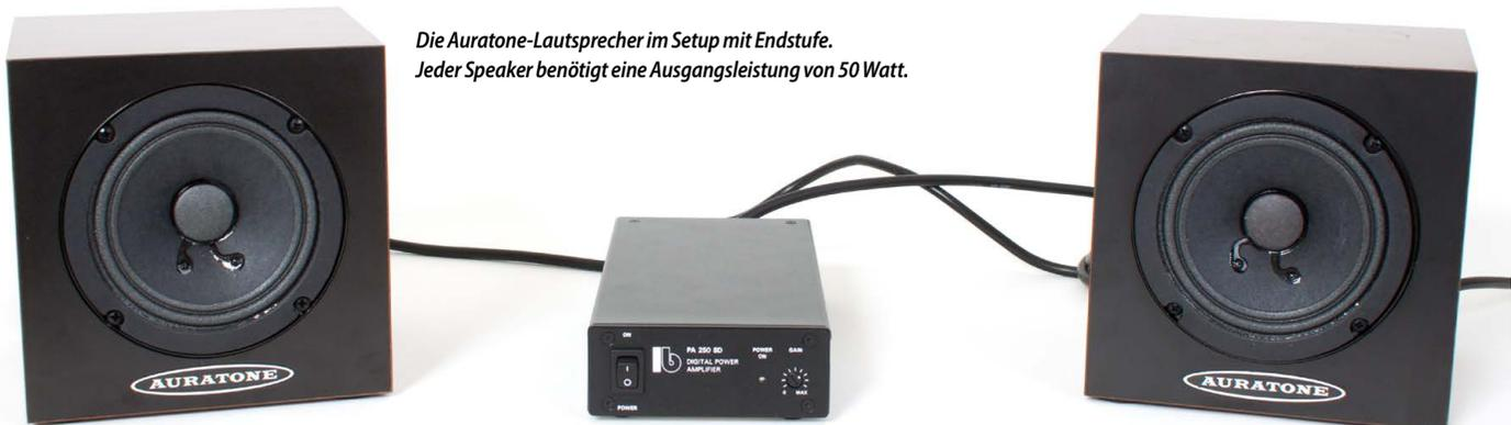
Die Auratone-Lautsprecher im Setup mit Endstufe. Jeder Speaker benötigt eine Ausgangsleistung von 50 Watt.
