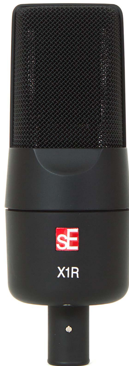
Günstiges, passives Bändchenmikrofon mit Achtercharakteristik und spartanischer Ausstattung: Das sE Electronics X1R
