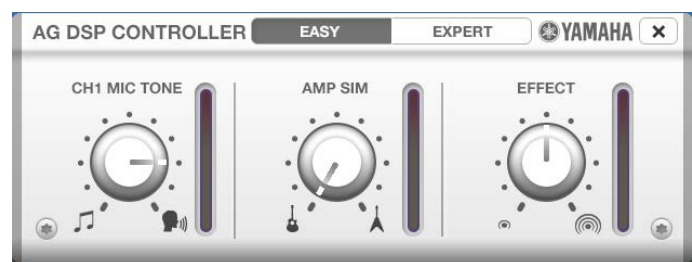
Über die Easy-Page des Effekt-Editors können rasch die Effekt-Stärken der per DSP berechneten Algorithmen reguliert werden.
