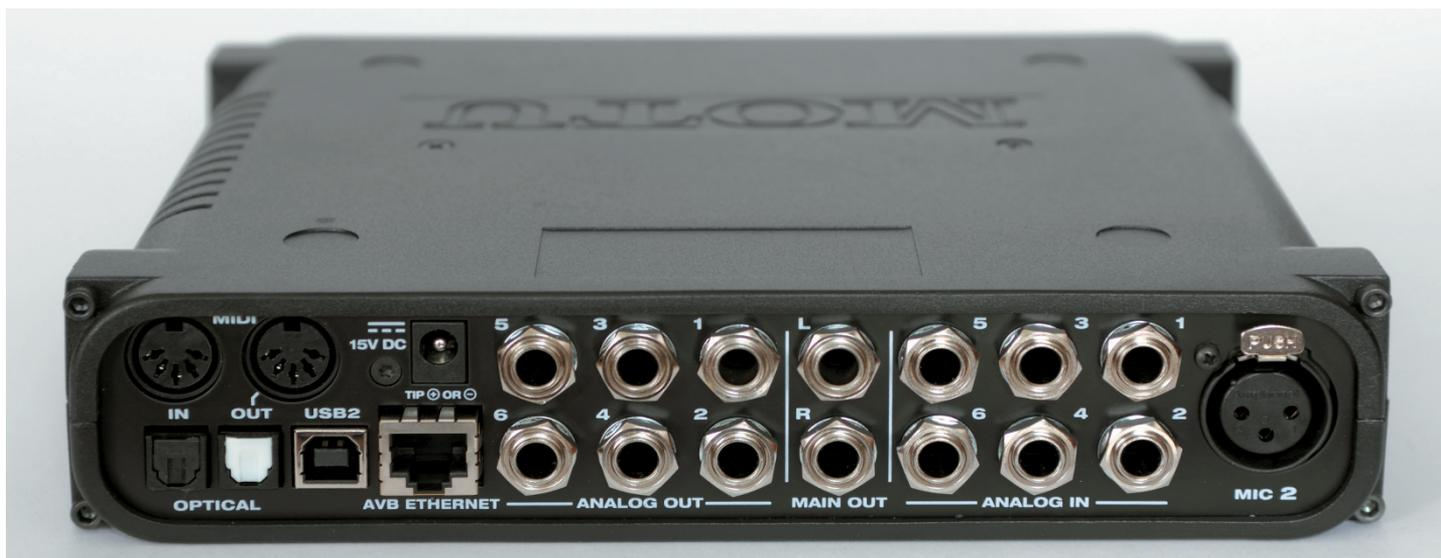
Mehr geht nicht! Die Rückseite des Ultralite AVB ist mit Anschlüssen geradezu übersät.
