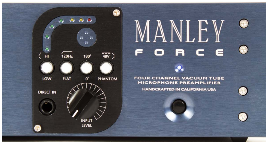
Alles drin, alles dran: Der Force geht mit seinem Gain-Staging Konzept eigene Wege und bietet neben den obligatorischen Preamp-Funktionen ein variables Input Pad, sowie ein zweites Vordämpfungs-Pad in Form eines Hi/Low Gain Schalters.
