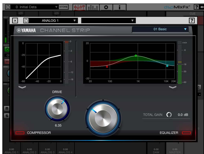
Der Yamaha Channelstrip-Inserteffekt besteht aus Kompressor und Dreiband-Equalizer.
