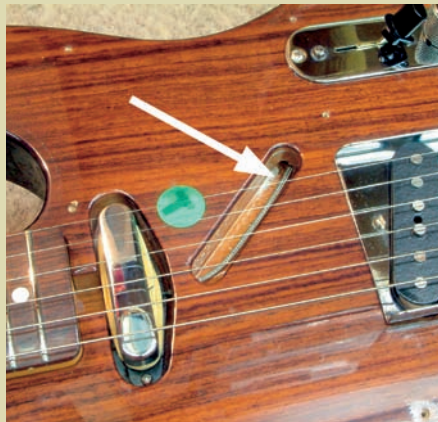
Abb. 9 Vorher ungeschützt, jetzt gut abgeschirmt: das Kabel vom Hals-Pickup zum E-Fach
