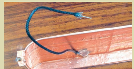
Abb. 5 Sicher ist sicher: extra Massekabel
