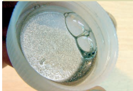
Abb. 3 Leitender Lack - gut zu erkennen: die einzelnen leitenden Partikel
