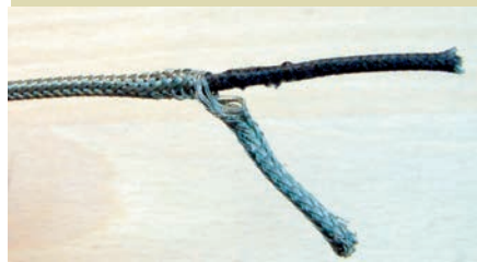
Abb. 1 Abgeschirmtes Kabel: Der innere Leiter wird durch das Metallgeflecht vor störenden Einstreuungen abgeschirmt
