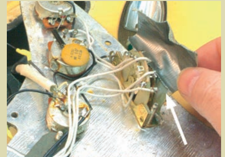
Abb. 5 Sicher ist sicher: extra Massekabel
