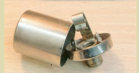
Abb. 7 Abschirmung total: Gekapselte Ausgangsbuchse
