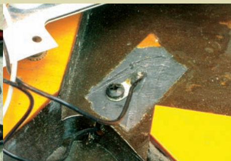
Abb. 10 Typische und gute Abschirmung à la Fender; man beachte die kleine Schraube, die den Abschirmlack mit der Masse verbindet
