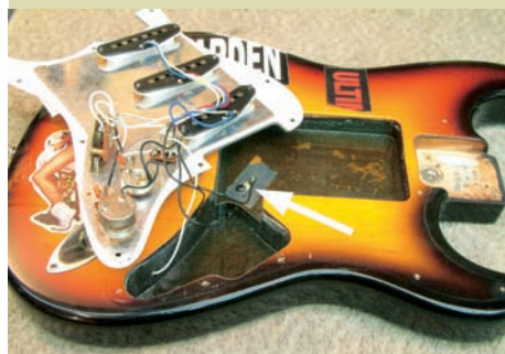
Abb. 10 Typische und gute Abschirmung à la Fender; man beachte die kleine Schraube, die den Abschirmlack mit der Masse verbindet
