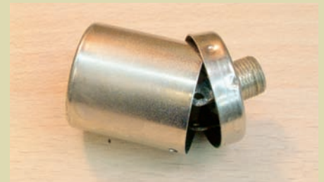
Abb. 6 Wenn nötig, Kontakte schützen - sonst gibt es einen Kurzschluss
