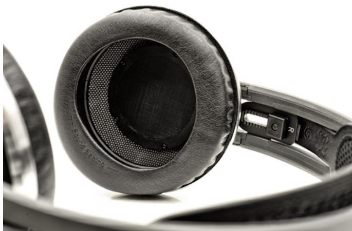
Die neu entwickelten Treiber mit ihrer übergroßen 53-Millimeter-Membran.
