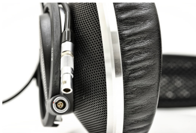
Professional: Anschlusskabel-Verbindung mit einem LEMO-Stecker.
